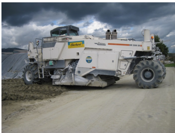
Engins de compactage et de stabilisation des sols
